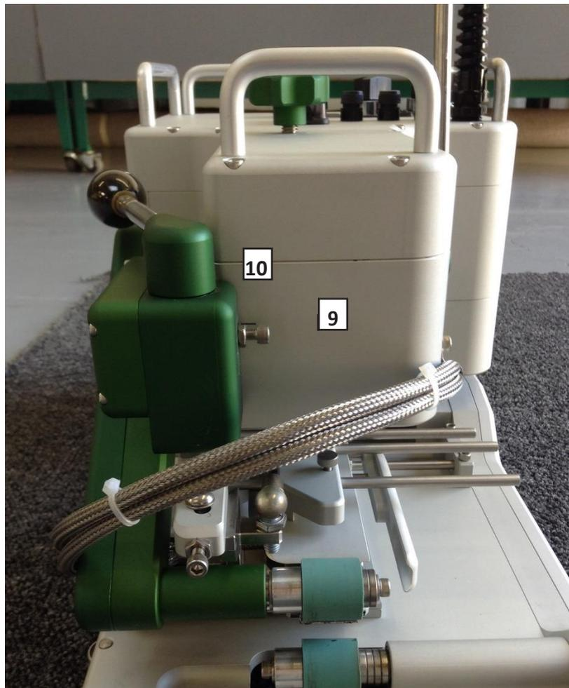
Realice una soldadura de prueba antes de realizar el trabajo. Los ajustes pueden ser realizados mientras la cuña está caliente. No pase la Cuña Caliente por los Rodillos de Silicón sin algún material en la maquina por periodos extensos, ya que esto distorsionará el silicón.
