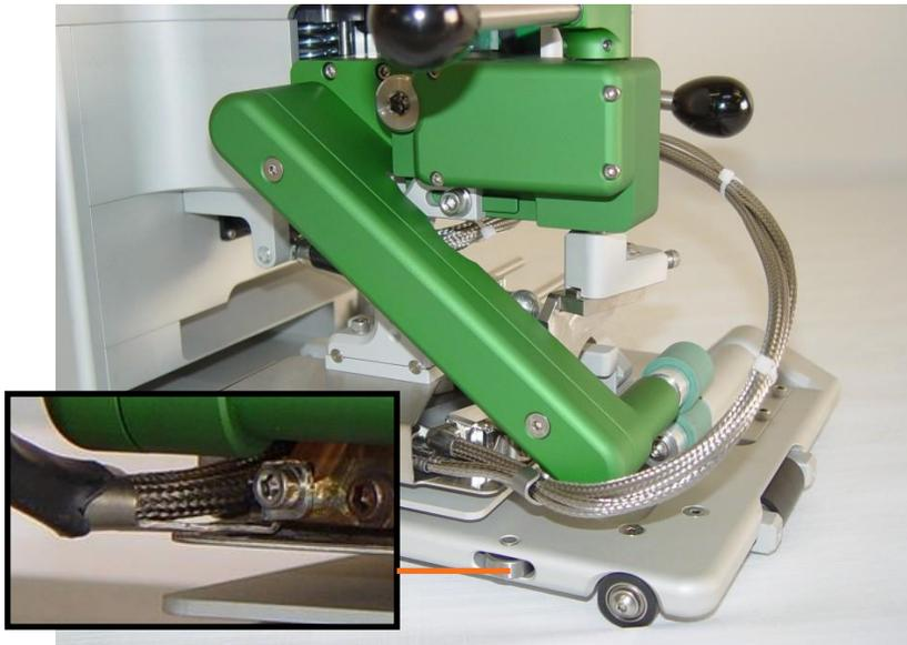
Instale la cuña en el brazo de soporte de la cuña con el soporte principal usando dos tornillos. Coloque los cables calentadores apropiadamente en el soporte principal y cierre suavemente para asegurarlos.
